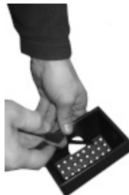
Fig. 34 - het schoonmaken van de vuurpot
